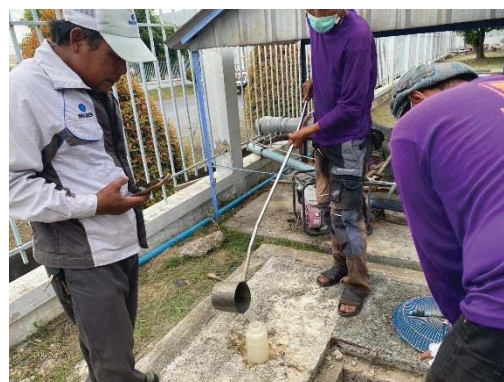
ภาพที่ 3.2.5.1-1 ตัวอย่างภาพการเก็บตัวอย่างน้ำเสียรายโรงงาน
