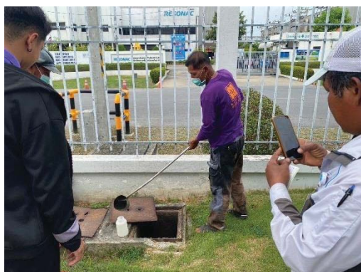
ภาพที่ 3.2.5.1-1 ตัวอย่างภาพการเก็บตัวอย่างน้ำเสียรายโรงงาน
